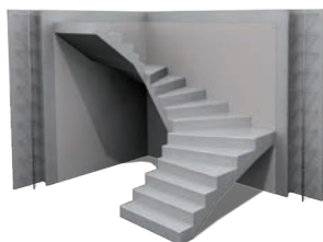
Filigránové steny a schody
